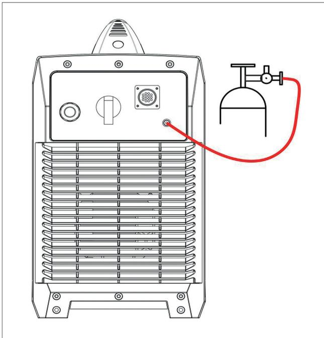
5. Collegare il regolatore del gas al cilindro gas e collegare la linea del gas al regolatore del gas.
