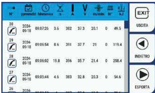
4. Ruotare l'encoder per selezionare l'impostazione desiderata. Selezionare il seguente percorso: Log saldature>
