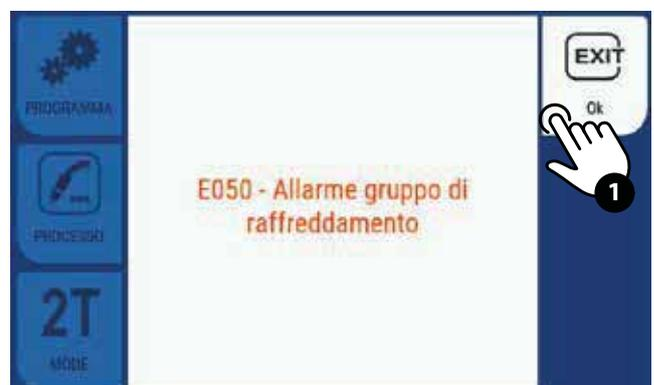
1. Premere il tasto (USCITA) per ripetere la procedura di riempimento torcia, finché non viene più visualizzato l'allarme.
