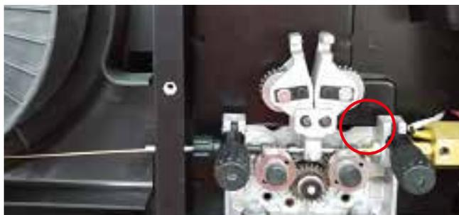
13. Allineare il filo nella scanalatura del rullo di azionamento e chiudere il rullo superiore assicurandosi che il filo sia nella scanalatura del rullo di trasmissione inferiore, bloccare il braccio di pressione in posizione. Applicare una pressione media al rullo di azionamento.
