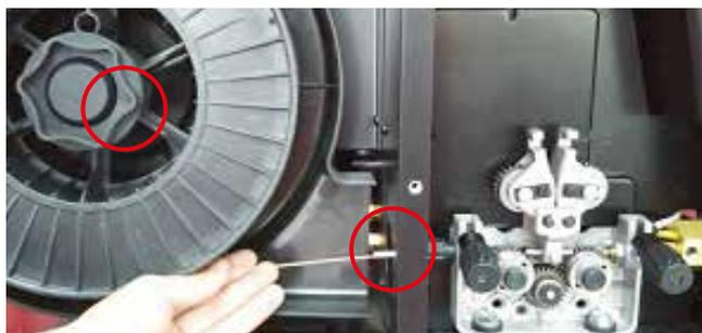
12. Far scorrere con attenzione il filo sopra il rullo di azionamento nel tubo di guida della presa e farlo avanzare per circa 150 mm nell'apposito connettore della torcia. Verificare che la dimensione del rullo di azionamento sia compatibile con il diametro del filo; sostituire il rullo se necessario.
