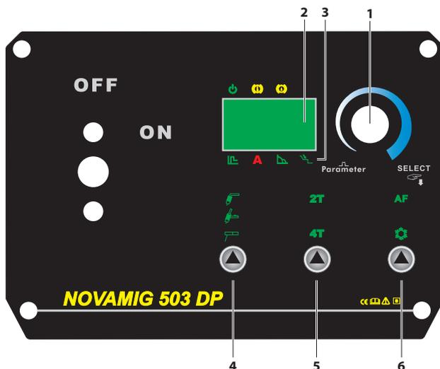
1. Impostazione Tempo pendenza discesa/ Corrente di saldatura
