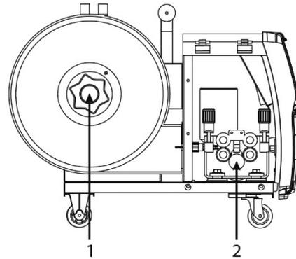
1. Assemblaggio del porta bobina
