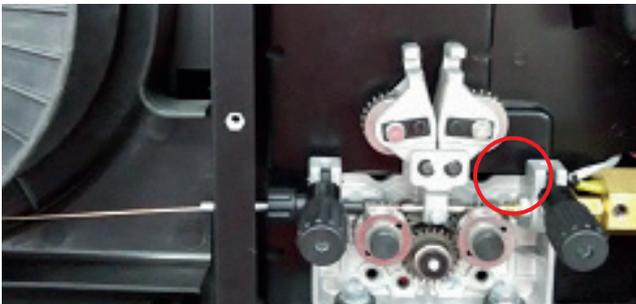
13. Allineare il filo nella scanalatura del rullo di trasmissione e chiudere il rullo superiore assicurandosi, che il filo sia nella scanalatura del rullo di trasmissione inferiore, bloccare il braccio di pressione in posizione. Applicare una quantità media di pressione al rullo di azionamento.
