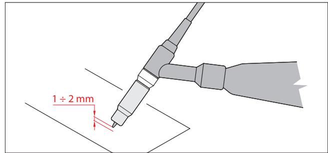
17. Con un piccolo movimento, ruotare la coppa gas in avanti in modo che l'elettrodo di tungsteno entri in contatto con il pezzo da saldare.
