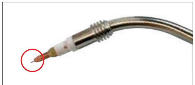
17. Montare l'ugello gas alla testa della torcia.
