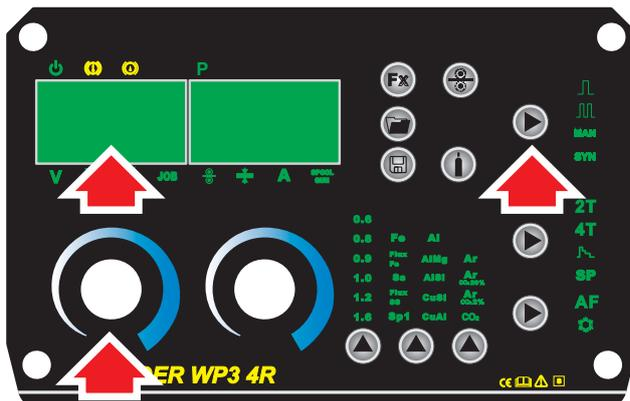
21. Impostare i parametri di saldatura adatti per lo spessore del materiale da saldare, che verrà visualizzato sul display digitale.
