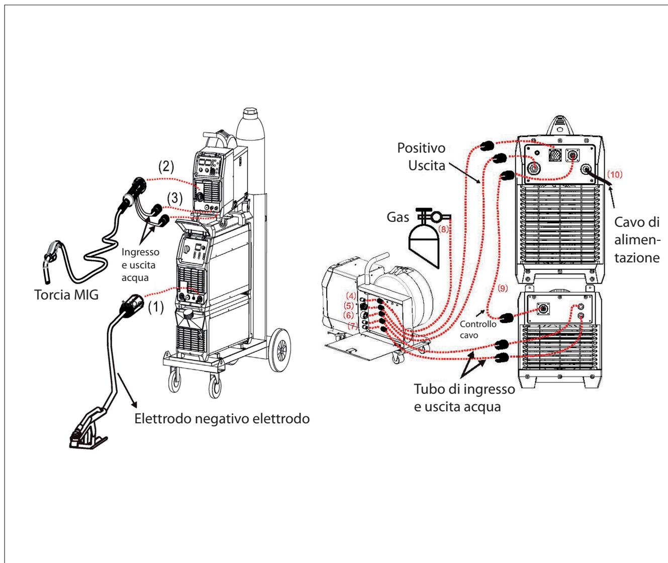
**NOTA: Modalità di raffreddamento ad aria senza dispositivo di raffreddamento, e il tubo dell'acqua non è necessario se si utilizza la modalità di raffreddamento ad aria.**
