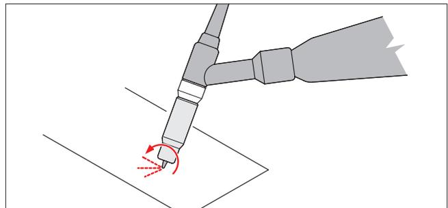
18. Ora ruotare la coppa gas nella direzione opposta, per sollevare l'elettrodo di tungsteno dal pezzo in lavorazione e creare l'arco di saldatura.
