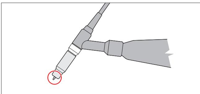
16. Posare il bordo esterno della coppa gas sul pezzo di lavoro con l'elettrodo in Tungsteno a distanza di circa 1- 2mm dal pezzo di lavoro. Tenere premuto l'interruttore della torcia per attivare il flusso di gas e la potenza richiesta per la saldatura.
