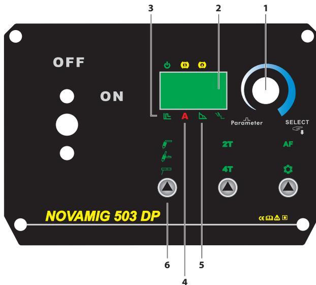
1. Impostazione Corrente di saldatura /Forza arco / Avvio a caldo
