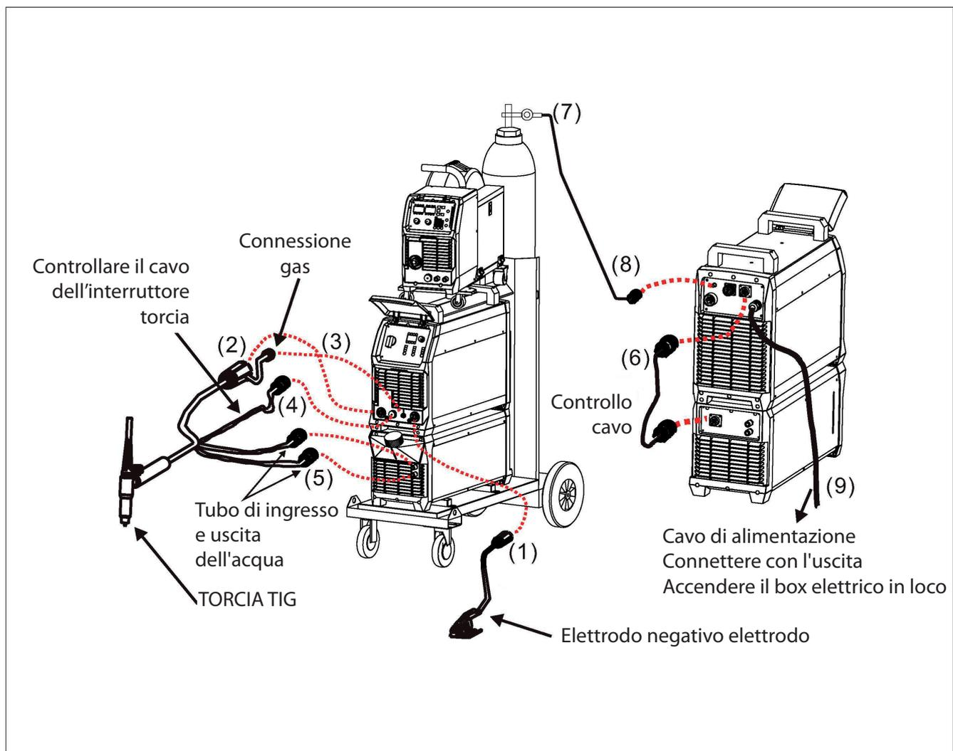
**NOTA: Modalità di raffreddamento ad aria senza dispositivo di raffreddamento, e il tubo dell'acqua non è necessario quando si utilizza la modalità di raffreddamento ad aria.**
