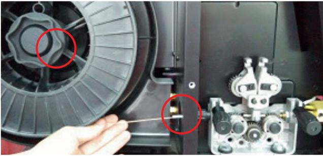
12. Alimentare con attenzione il filo sopra il rullo di azionamento nel tubo di guida della presa, guidalo per circa 150 mm nell'apposito ricettacolo della torcia. Verificare che la dimensione del rullo dell'azionamento sia compatibile con il diametro del filo, sostituire il rullo se necessario.
