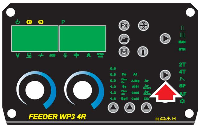
20. Selezionare la funzione MIG-MAG richiesta, Selezionare il numero di programma adatto per il diametro del filo e il tipo di gas in uso, verrà visualizzato sul display digitale.
