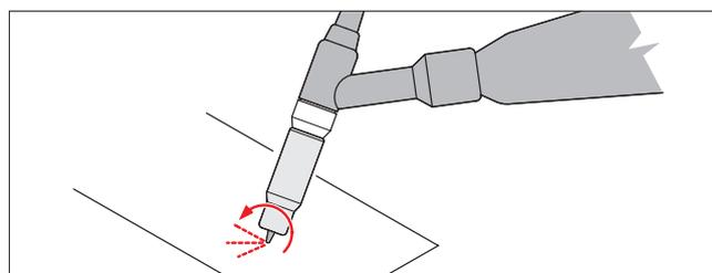
19. Ora ruotare l'ugello del gas nella direzione opposta, per sollevare l'elettrodo di tungsteno dal pezzo in lavorazione e creare l'arco di saldatura.
