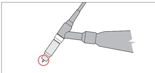
17. Poggiare il bordo esterno dell'ugello del gas sul pezzo da lavorare e l'elettrodo in tungsteno a una distanza di circa 1- 2mm dal pezzo di lavoro. Tenere premuto l'interruttore della torcia per attivare il flusso di gas e raggiungere la potenza richiesta per la saldatura.
