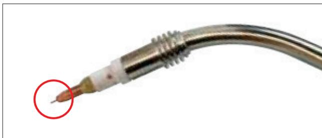
15. Montare l'ugello del gas sulla testa della torcia.
