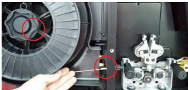
10. Far scorrere con attenzione il filo sopra il rullo di azionamento nel tubo di guida della presa e farlo avanzare per circa 150 mm nell'apposito connettore della torcia. Verificare che la dimensione del rullo di azionamento sia compatibile con il diametro del filo; sostituire il rullo se necessario.
