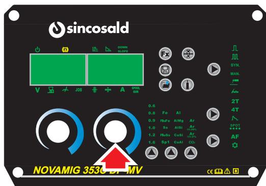
15. Selezionare tempo rampa di discesa discesa come richiesto sul pannello anteriore. Il tempo rampa di discesa verrà visualizzato sul misuratore digitale.
