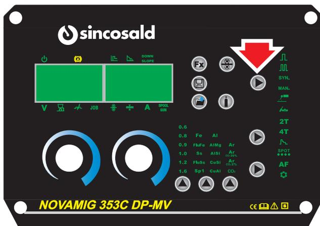
19. Selezionare il codice di programma adatto per il diametro del filo e il tipo di gas in uso; il codice verrà visualizzato sul display digitale.
