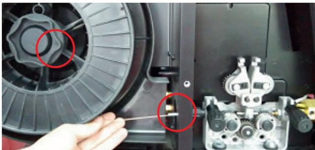
9. Far scorrere con attenzione il filo sopra il rullo di azionamento nel tubo di guida della presa e farlo avanzare per circa 150 mm nell'apposito connettore della torcia. Verificare che la dimensione del rullo di azionamento sia compatibile con il diametro del filo; sostituire il rullo se necessario.
