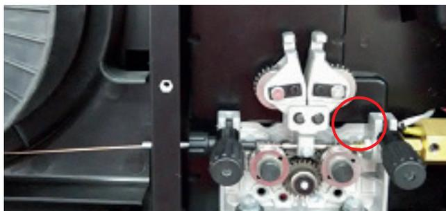
11. Allineare il filo nella scanalatura del rullo di azionamento e chiudere il rullo superiore assicurandosi che il filo sia nella scanalatura del rullo di trasmissione inferiore, bloccare il braccio di pressione in posizione. Applicare una pressione media al rullo di azionamento.
