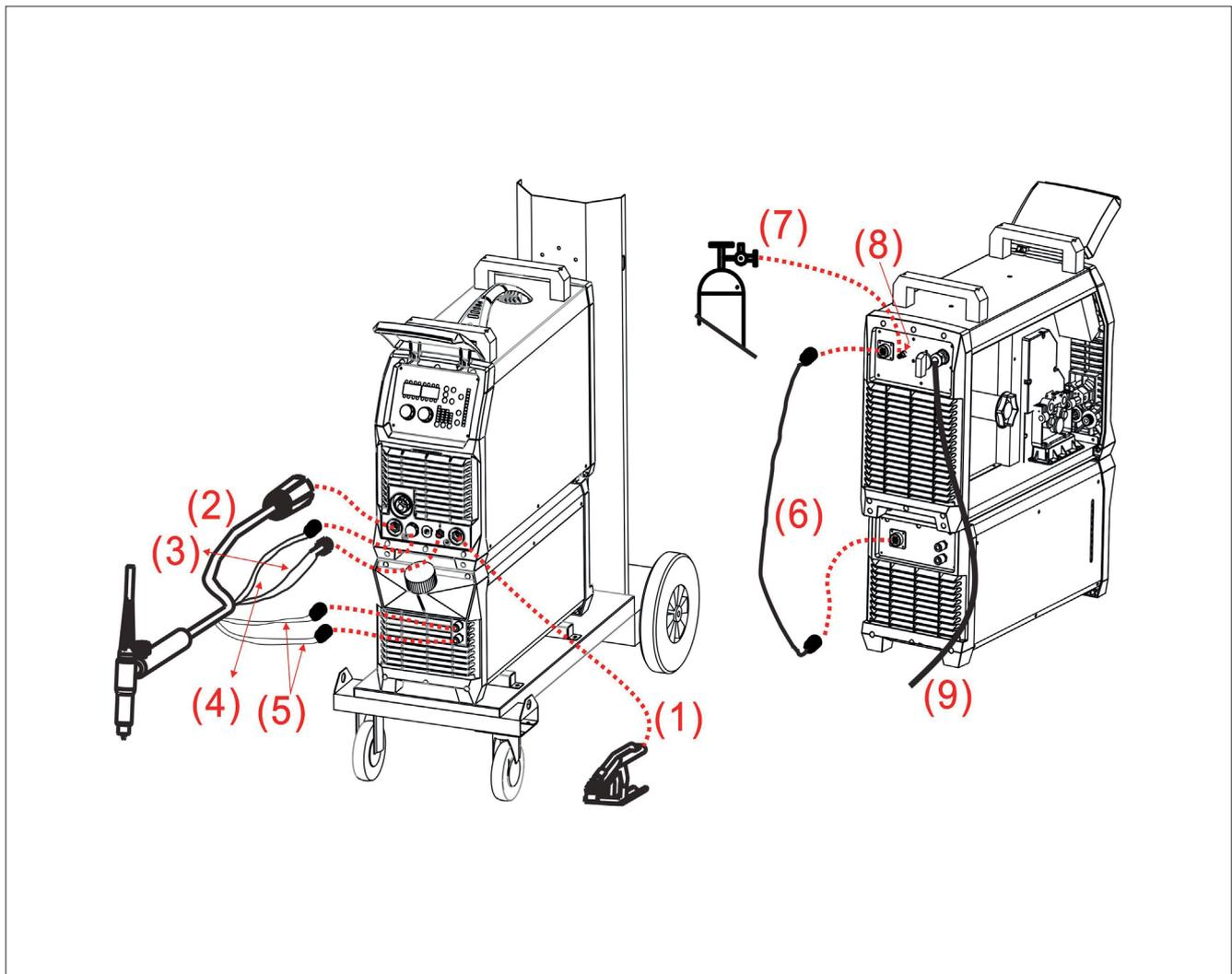
**NOTA: Modalità di raffreddamento ad aria senza dispositivo di raffreddamento. Il tubo dell'acqua non è necessario quando si utilizza la modalità di raffreddamento ad aria.**
