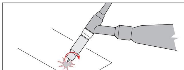
20. Rilasciare l'innesco per arrestare la saldatura.
