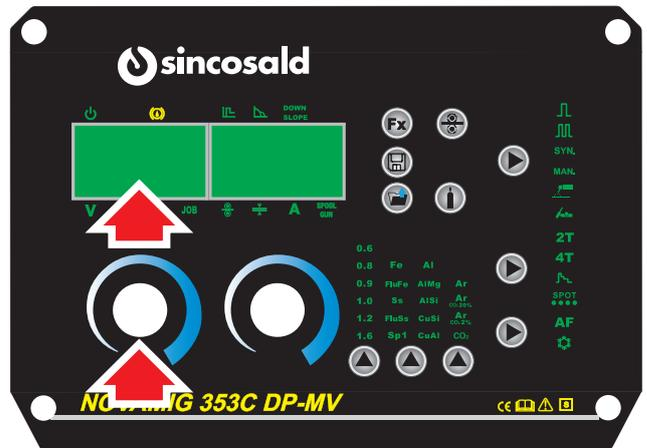
20. Impostare i parametri di saldatura adatti per lo spessore del materiale da saldare; appariranno sul display digitale.
