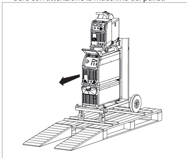
Nel caso sia presente la sola saldatrice questa deve essere movimentata tramite la comoda maniglia presente nella parte superiore della saldatrice stessa.
