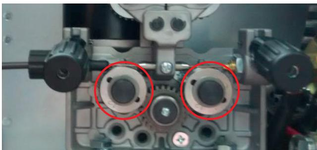
8. Posizionare la bobina del filo sul supporto apposito. Prelevare il filo dalla bobina, tenendolo saldamente per evitare che si srotoli rapidamente. Inserire il filo nell'ingresso del trainafile attraverso il rullo di azionamento.
