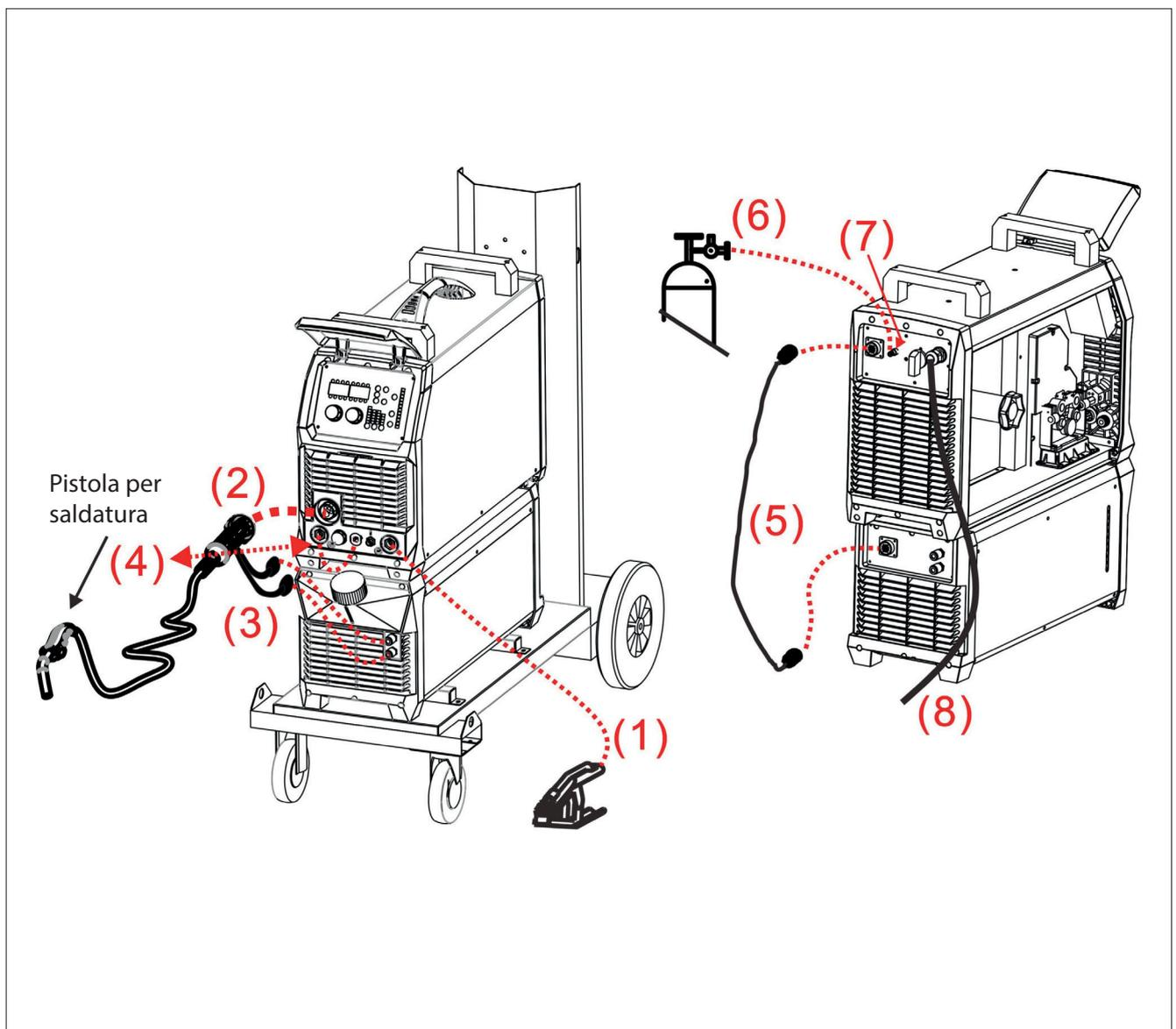
**NOTA: Modalità di raffreddamento ad aria senza dispositivo di raffreddamento; il tubo dell'acqua non è necessario se si utilizza la modalità di raffreddamento ad aria.**
