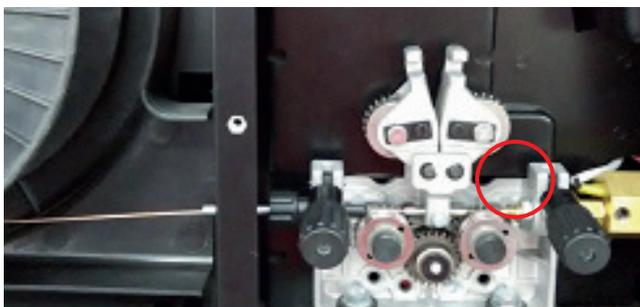
10. Allineare il filo nella scanalatura del rullo di azionamento e chiudere il rullo superiore assicurandosi che il filo sia nella scanalatura del rullo di trasmissione inferiore, bloccare il braccio di pressione in posizione. Applicare una pressione media al rullo di azionamento.
