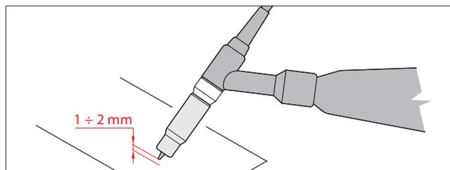
18. Con un piccolo movimento, ruotare l'ugello del gas in avanti in modo che l'elettrodo di tungsteno entri in contatto con il pezzo da saldare.
