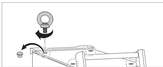
**Non sollevare la macchina dalle maniglie del FEEDER o del generatore.**
