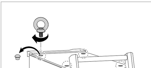
**Non sollevare la macchina dalle maniglie del FEEDER o del generatore.**
