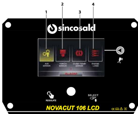
Questa interfaccia compare quando la saldatrice non riceve gas o la pressione dell'aria è insufficiente.
