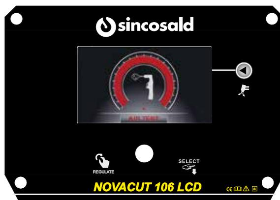
Tenere premuto il pulsante (8) per 2 secondi per inserire il gas di controllo; il display visualizzerà l'interfaccia specificata sopra.
