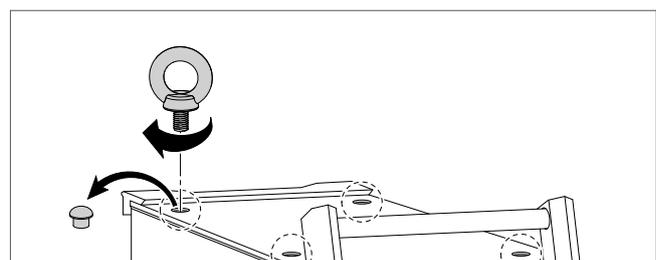
**Non sollevare la macchina dalle maniglie del FEEDER o del generatore.**
