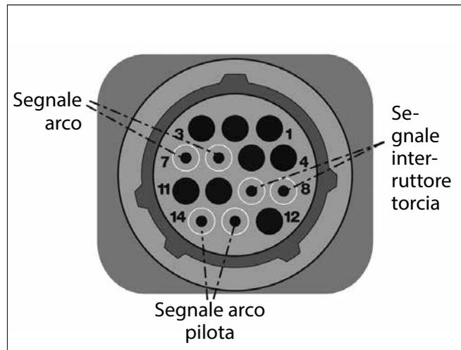
Fare riferimento alla seguente tabella quando si collega il sistema CUT ad un controllore di altezza torcia o ad un controllore CNC con un cavo di interfaccia macchina.
